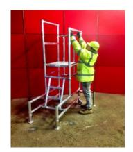
10) MOVE SIDE FRAMES UP AND LOCATE CLIPS IN **HOLES**
